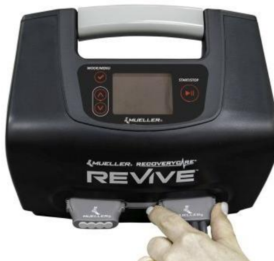
Figura 20 - Cómo conectar el conjunto de mangueras de la prenda a la consola
