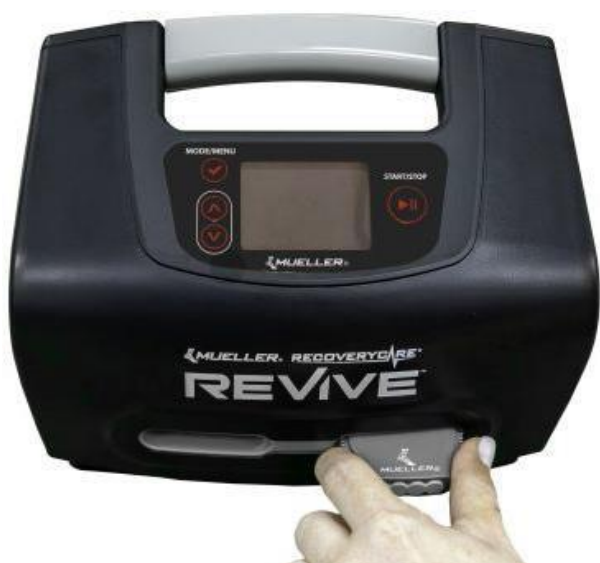
Figura 21 – Inserindo a Ficha Prong para Bloquear a Saída de Ar Não Usada para Uso de Apenas Uma Roupa
