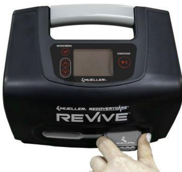
Rysunek 21 - Wkładanie wtyczki do gniazda, aby zablokować nieużywany otwór powietrzny w przypadku używania pojedynczego ubrania
