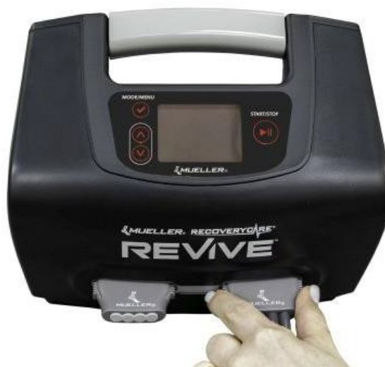
Rysunek 20 - Podłączanie wiązki przewodów do konsoli
