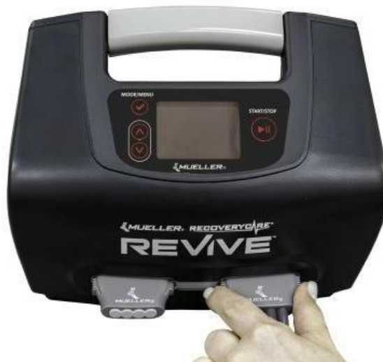
Figura 20 - Collegamento del fascio di cavi alla console
