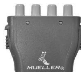
Abbildung 21 – Einsetzen des Verschlussstopfens zum Blockieren der nicht belegten Druckluftbuchse bei Verwendung einer einzelnen Manschette
