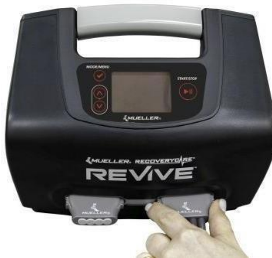
Figur 20 - Tilslutning af slangerne til kontrolenheden
