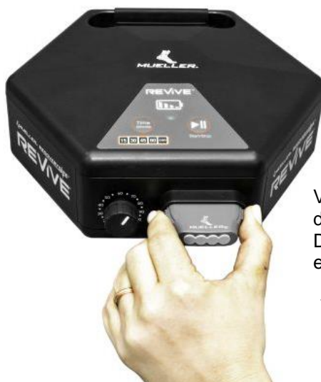
Abbildung 13 – Einsetzen des Verschlussstopfens zum Blockieren der nicht belegten Druckluftbuchse bei Verwendung einer einzelnen Manschette
