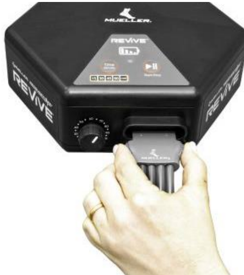
Abbildung 12 – Verbinden des Manschetten-Leitungsbündels mit der Konsole
